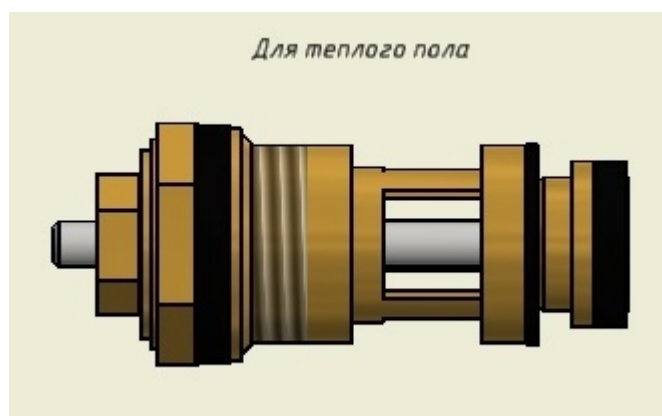
Стандартная термостатическая вставка трехходового клапана модуля
